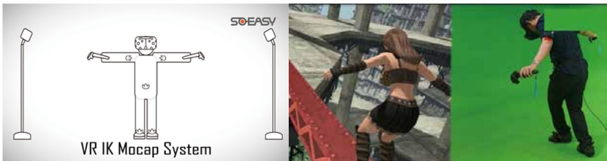
VIVE 移動定位器使用無線、無縫的方式連接VIVE系統與附加工具，能夠以前所未有的自由度發展與體驗虛擬實境遊戲。透過8個 Steam VR 追蹤點實現的低成本動捕系統 Project Orion，追蹤點設置在雙腳、雙手、腰部和頭部。所有這一切都由兩個標準的 Steam VR定位器進行追蹤。現在，得益於 Vive Trackers (移動定位器)，VR動捕帶來更令人信服的動作捕捉技術。應用了逆向運動學 (inverse kinematics，用骨架結構來解析真實運動的系統) 來填補定位點之間的空白，讓 VR 中人的運動更加形象真實。
